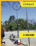
方向別交通量をカウンタバーにより車種別に即時計測
