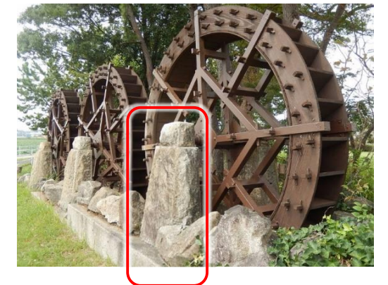
【参考】豊田市広美町 三連水車（明治期） （赤枠内が水車の軸受部分）
