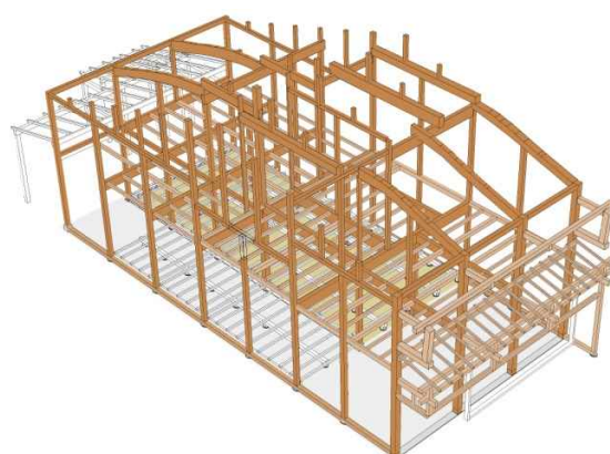
架構図（現況）軸組のみ
