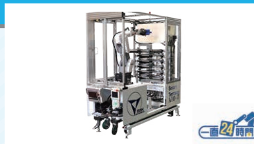
多品種少量生産と、材料や機器の交換を自動化するシステム
