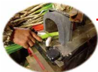
根切りを行った後、機械による皮むきを行う
