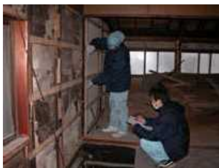
耐震性向上マニュアル作成のための現地実態調査（左：軸組の実測 右：常時微動の計測）
