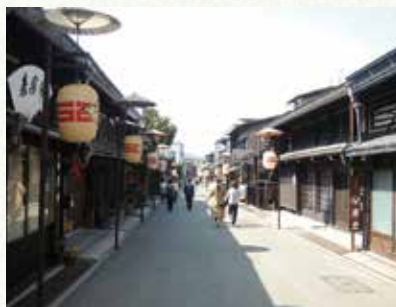
無電柱化した下二之町大新町地区
