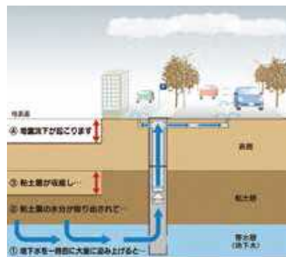
図 地盤沈下のメカニズム
