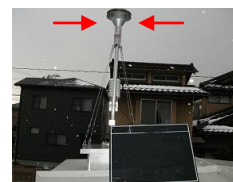
西南部測定局のPM2.5用大気導入口
