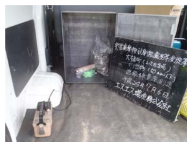
遮蔽線量率サンプル測定
