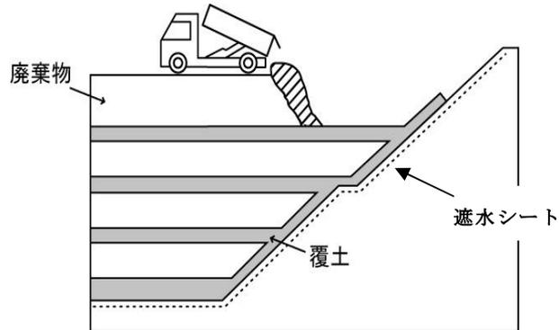
図3 埋立方式（サンドイッチ方式）
