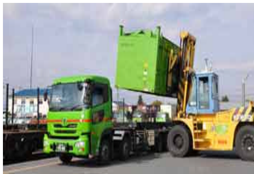
③コンテナ積み下ろし方式
