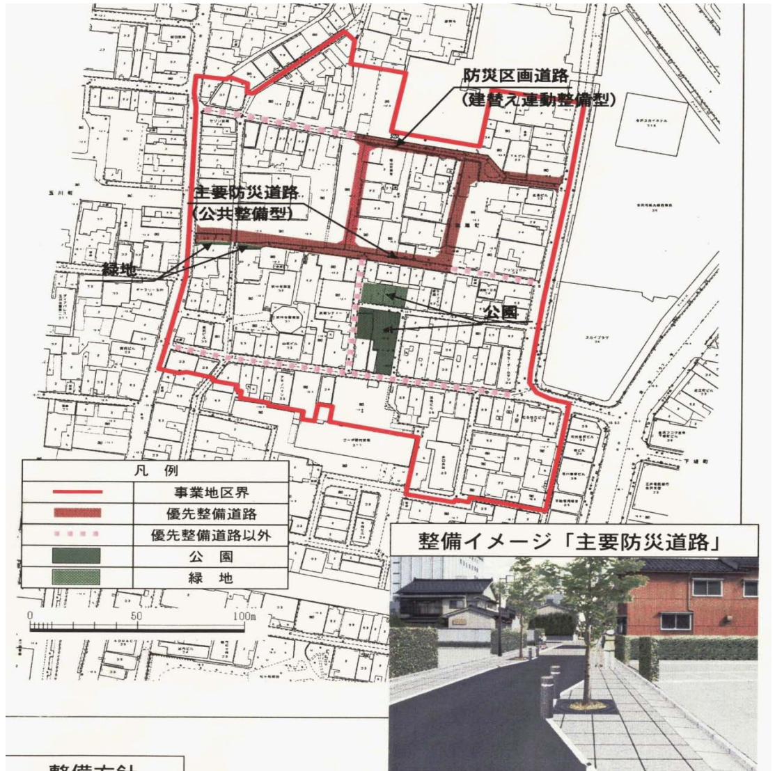
■住宅市街地総合整備事業(密集住宅市街地整備型)による整備(武蔵地区)■
