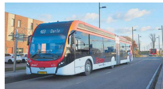
フルフラット連節電気バス （オランダ・アイントハーベン市） （VDL社製CITEA SLF/SLFA ELECTRIC）
