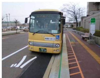
バス正着状況 (H28構内道路)
