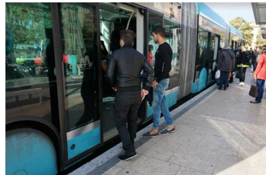
信用乗車の事例（フランス メッスBRT） （各扉から乗降することによる停車時間短縮）
