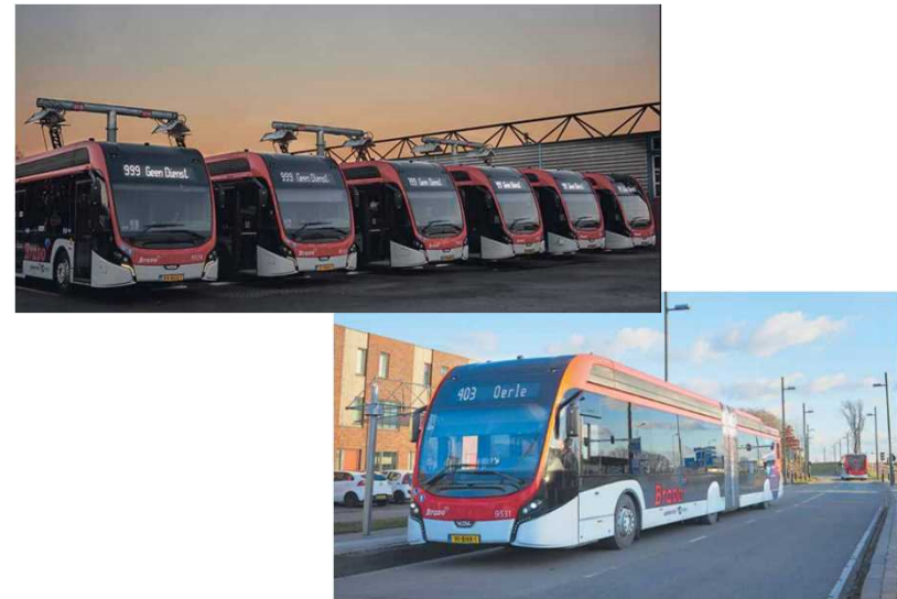
フルフラット連節電気バス（オランダ・アイントハーベン市） （VDL社製CITEA SLF/SLFA ELECTRIC）
