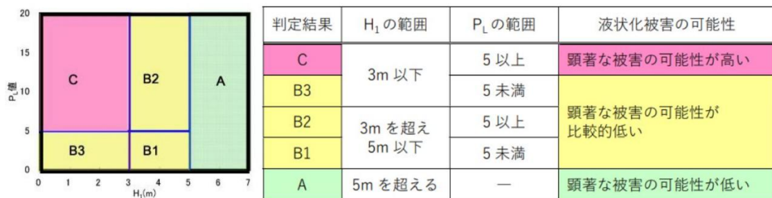
図2-6-4 H 1 -PLによる液状化可能性判定図・数値
