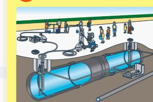
地震などの災害時に皆さんの飲料水を確保するために40トンの耐震性貯水槽を埋設しています。
