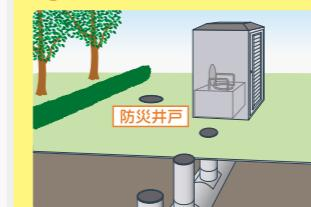
災害時にはマンホールの上に簡易トイレを設置して利用します。防災井戸はマンホールトイレの流水用として利用するほか、災害時の生活用水として利用します。
